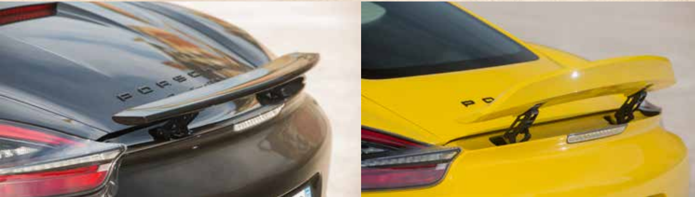
Disposant d'une lèvre plus prononcée, l'aile du Cayman procure davantage d'appui aérodynamique
