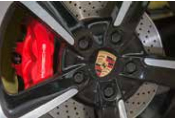
Avec 330 mm à l'avant et 299 mm à l'arrière, les freins sont identiques sur les deux modèles
